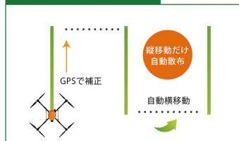
初心者の方でも簡単に散布できるように、直進アシストモードが標準で装備されています。GPSを使用して飛行経路がズレないように自動で補正され、速度は15kmで固定。散布装置も縦線だけを散布するように連動散布します。ホバリング時や横移動時は散布装置が自動停止するので毎回操作する必要はありません。スイッチひとつで4m自動横移動でき、誰が操作しても同じ作業品質を保つことができます。
