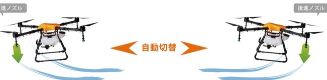
前進は前側ノズル、後進は後側ノズルから噴霧するように自動制御されます。ノズルから噴霧された瞬間に前側プロペラのダウンウォッシュで薬剤を吹き落し、その上を通過する後側プロペラでさらに薬剤を抑え込み、前後進でも散布性能を変えません。
