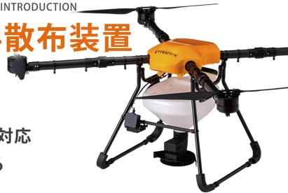
粒剤や肥料散布でも高い散布性能を実現するために開発をはじめ、薬剤の流れや勢い、タンクの形状、インペラのフィン形状など様々な視点から研究し、より均等に散布する装置が完成しました。認定機と同じ性能で、タンクの蓋を開ければ簡単に薬剤の補充を行うことができバッテリーも上に乗せるだけ！吐出量やインペラの回転速度は送信機で操作できます。大幅な改善を行い、詰まりなどのトラブルが減少しています。
