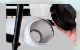
大型機と同様の大きな投入口になったことで、タンク内の清掃が容易になり、円錐形の形状をしているので内部に残る薬剤量を削減します。標準で大型ストレーナーも付属するので、液体薬剤に混入している不純物も簡単に取り除くので作業効率が向上します。
