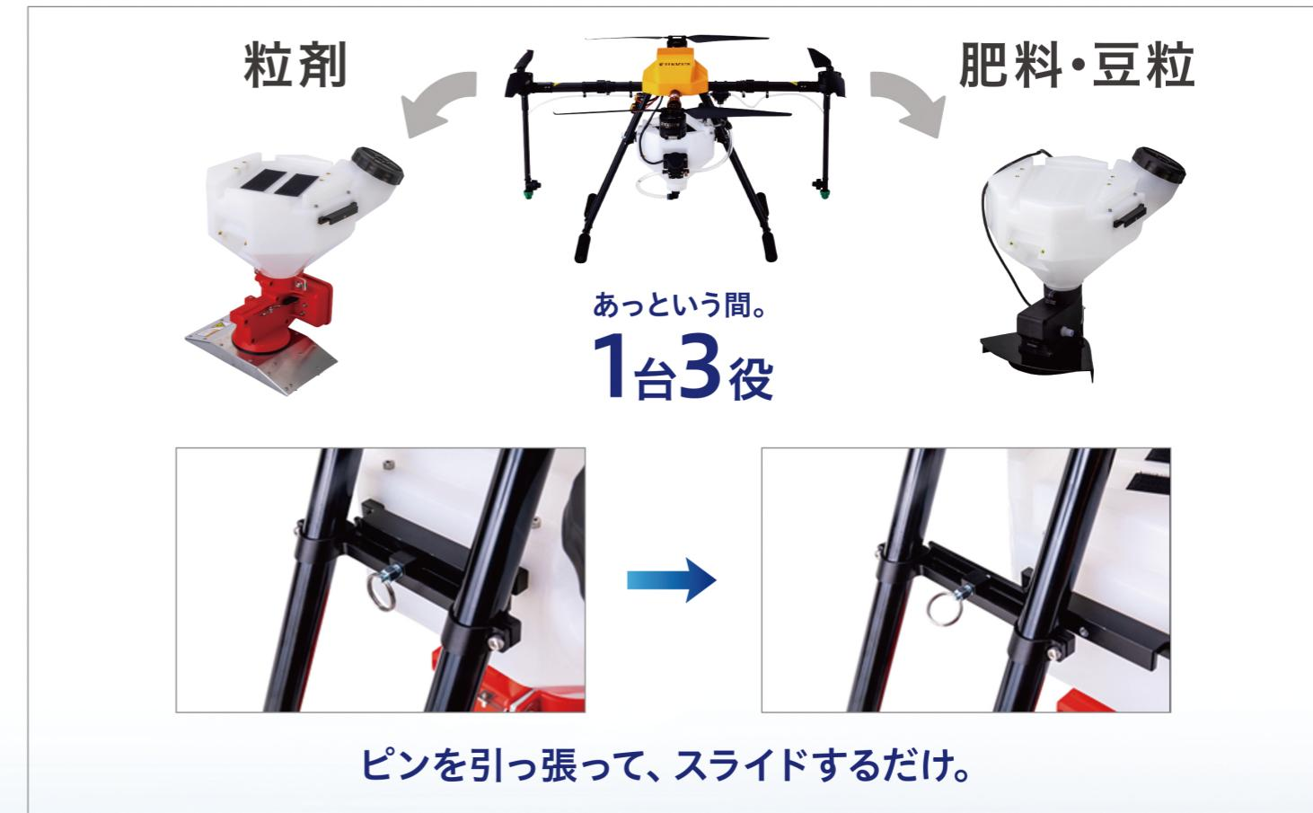
飛助miniは、液体薬剤はもちろん、粒剤散布装置や肥料・豆つぶ散布装置※1にも対応します。簡単なアタッチメント式で、装置の交換時間はわずか1分! 忙しい合間でも簡単に装置の交換が可能になりました。もちろん飛行中に散布装置が落下しないようロック式のピンで固定しています。
