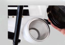
大型機と同様の大きな投入口になったことで、タンク内の清掃が容易になり、円錐形の形状をしているので内部に残る薬剤量を削減します。標準で大型ストレーナーも付属するので、液体薬剤に混入している不純物も簡単に取り除くので作業効率が向上します。
