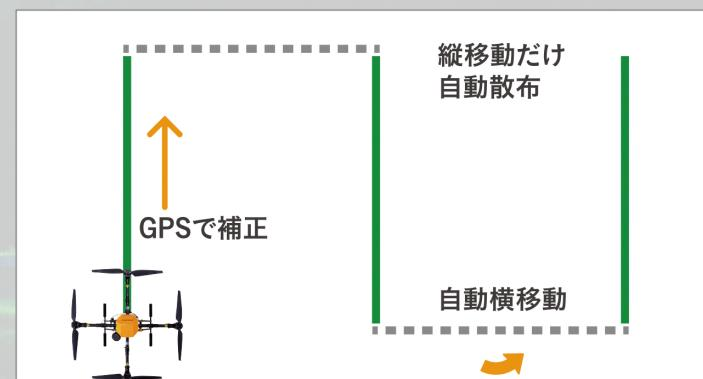
初心者の方でも簡単に散布できるように、直進アシストモードが標準で装備されています。GPSを使用して飛行経路がズレないよう自動で補正され、速度は15kmで固定、散布装置も縦線だけを散布するように自動制御します。ホバリング時や横移動時は散布装置が自動停止するので毎回操作する必要はありません。スイッチ一つで自動で4m横移動を行うので、作業者が変わっても正確な散布幅で作業できるので散布ムラを低減します。
