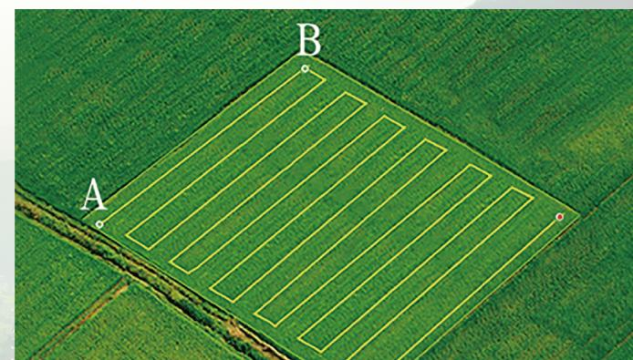
A地点、B地点の上空でスイッチを押すだけで自動散布飛行が可能です。横移動や前後移動、散布装置のON・OFFも全て自動制御します。前後移動の時だけ散布装置がONになり、ホバリング時と横移動時は散布装置がOFFになるので薬剤を不用意に落させることはありません。本機はタブレットやモニターを使用しないので、太陽光の熱によるアプリと接続できない、などの不具合リスクを抑えることができます。
