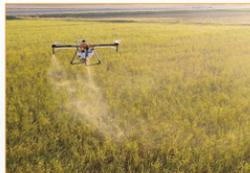
同じ重量を持ち上げる場合、構造上4個モーターの場合は30インチの大きなプロペラを使用することができます。国立研究開発法人の实地試験でも、「プロペラがより大きいほど降下気流の中に薬剤を留めて散布することができます。」と結果が出ています。ダウンウォッシュが強い利点は、薬剤が風に流れにくくなり舞い上がる量を抑えます。また、しっかりと吹き降ろすことで作物の葉裏や根元まで均一に散布することができます。
