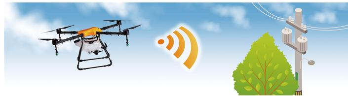
飛行中の安全性を向上するために、新型モデルより障害物センサーの搭載が可能になりました。最も飛行中のリスクが高い前方の135°の広範囲を高密度ミリ波レーダーで障害物検知します。センチ幅の送電線や木の枝などの障害物も検知する事が可能で機体を安全に飛行させることができます。また耐薬・防水性に優れ、薬剤が付着しても安心です。
