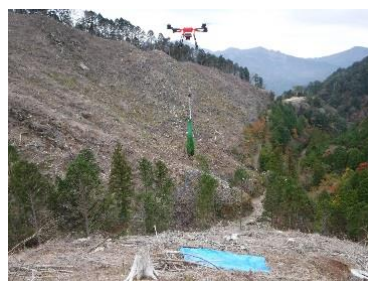
苗木を運搬中の本機ドローン
