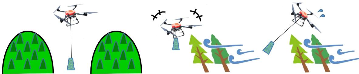
山の斜面に囲まれた場所に苗木を下ろす場合、通常なら機体が斜面に接触する恐れがあるところを、ウインチを使うことで、機体は安全な位置でホバリングした状態で苗木を降下することが出来ます。
