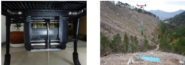
苗木の昇降をドローンに取り付けられたウインチで行うことで、ドローン本体の動作を最小限にし、山林特有の複雑な地形がもたらす操縦の難しさを軽減します。また、苗木の運搬時には、ウインチによって苗木が巻き上げられた状態で飛行することで、突発的に吹く風にも強く、安全かつ省力的に飛行することが出来ます。
