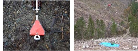
傾斜のある植栽現場において、ドローンを着陸させることは困難であり、だからといって、苗木を投下するわけにもいきません。そこで、苗木が着地したときの張力の変化で自動的に外れる仕組みを持った「自動フック」を採用。これによって、荷外しの作業が不要になるため大幅な省力化となるだけでなく、作業者の安全性も同時に確保できます。
