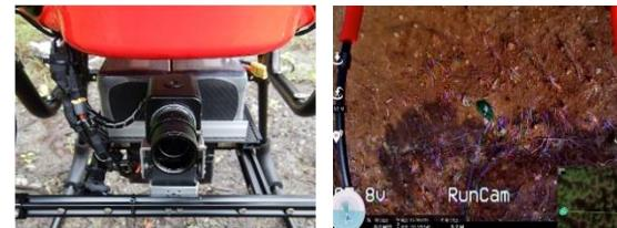
一人作業による苗木運搬を実現するためには、離れた目的地の状態を確認する必要があります。本機では、ドローンに搭載したカメラで荷下ろしの状態を確認することによって、目的地での確実な荷下ろしをサポートします。またカメラは、プロポの操作で見る角度を変えることが出来るため、離れた目的地でも、周囲の状況を確認することも出来ます。
